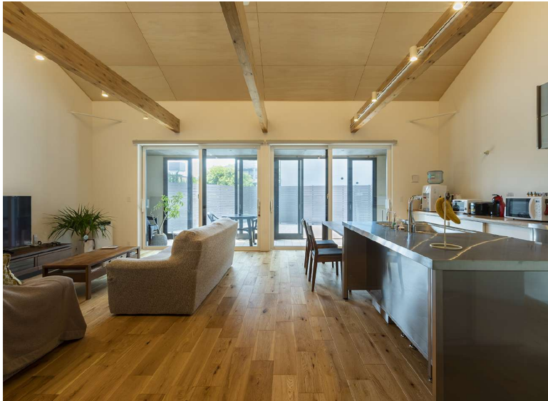
▲構造計算による大開口のLDK。温度差が発生しないように家全体にトリプルサッシを採用。断熱材の厚みも増やし快適な空間を実現しています。
