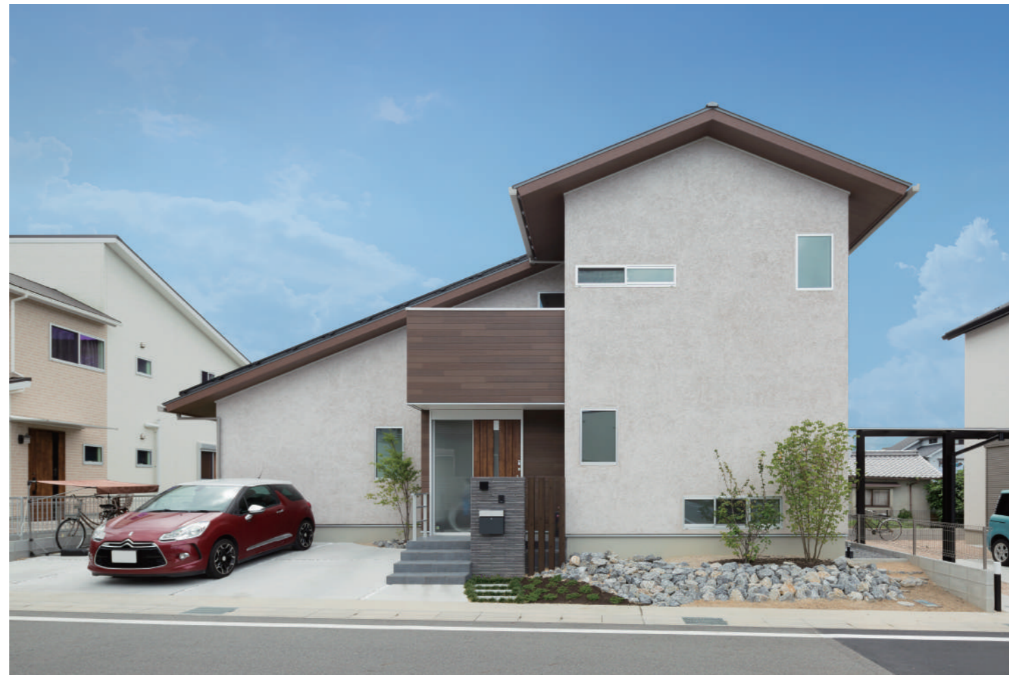
▲100%自然素材で防水と透湿を兼ね備えた外壁材「スーパー白洲そとん壁」を採用。
