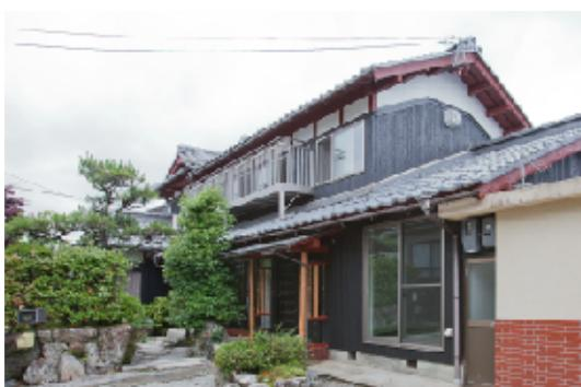
(上)色あせと雨漏りが気になっていた外壁は、下地に防水シートを貼り、塗装を施した杉板で仕上げ、質感のある引き締まった外観に生まれ変わりました。玄関ポーチ柱、破風も塗装をし、新築の様な仕上がりです。
